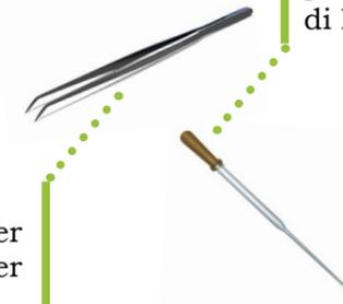
**PINZE** Quelle in legno sono adatte per scaldare le provette. In metallo servono per maneggiare piccoli campioni
